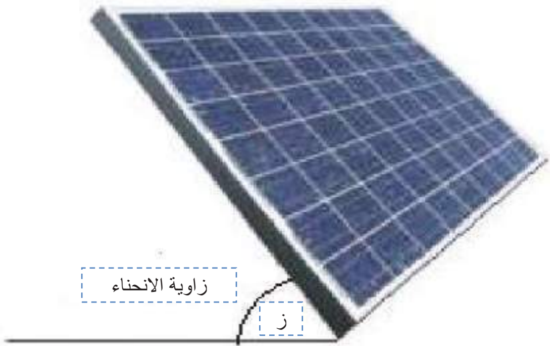
صورة بيانية رقم 3 : زاوية انحناء الوحدات الكهروضوئية
