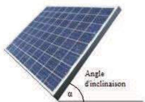
Fig. 3: Angles d'inclinaison des modules photovoltaïques
